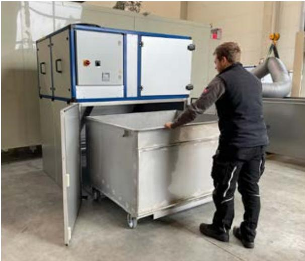
Filtergepresster Schlamm wird auf eine Restfeuchte von circa 15 % getrocknet. Die integrierte Wärmepumpe sorgt für eine energiesparende Trocknung und steigert die Einsparungen um ein weiteres.
