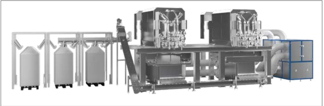
Aus den beiden Kammerfilterpressen fällt der Schlamm in die darunter befindlichen Trocknungsbehälter. Von dort aus wird der getrocknete Schlamm über ein Fördersystem automatisch zu den Big Bags der Entleerungsstation gefördert. Rechts im Bild das Entfeuchtungsmodul zur Aufbereitung der erforderlichen Prozessluft.
