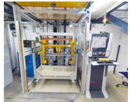
Be- und Entladestation mit Dockwagen und Hubeinrichtung
