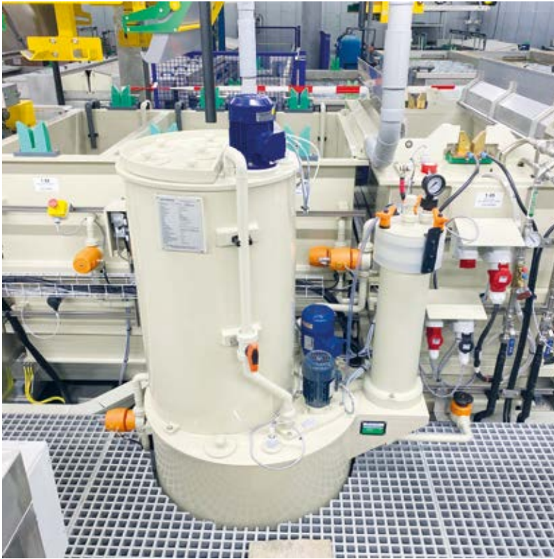
Lösestation für Zinkanoden für das Zink-Nickel Bad
