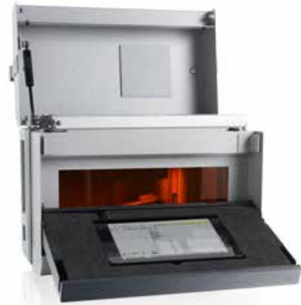
„XAN 500 Tiefdruckzylinder.jpg“ Bildunterschrift: Messung an Tiefdruckzylindern mit dem portablen XAN 500
