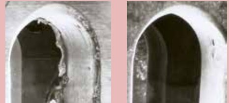
Schnittkante zweier sich kreuzender Bohrungen – vor und nach der Entgratung mit chemischem POLIGRAT-Verfahren.
