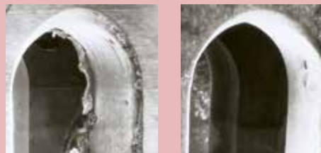
Schnittkante zweier sich kreuzender Bohrungen – vor und nach der Entgratung mit chemischem POLIGRAT-Verfahren.
