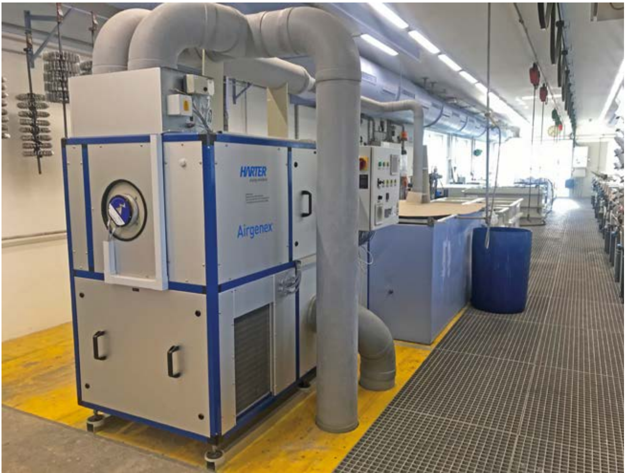
Das Entfeuchtungsmodul bereitet die erforderliche Prozessluft auf. Die integrierte Wärmepumpentechnik arbeitet so energieeffizient, dass sie staatlich gefördert wird.
