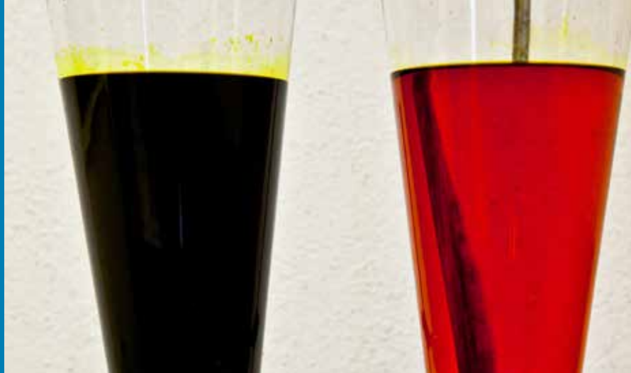
Elektrolyt vor und nach der Reinigung
