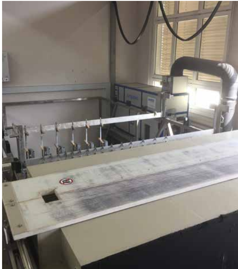
Gestelltrockner mit Deckel, im Hintergrund das Airgenex®-Entfeuchtungsmodul
