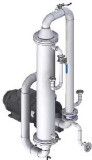
Die kompakte Konstruktion im 3D-Modell und der Einbau der Ultrafiltration.
